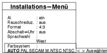
▼▲ drücken, um zum "Farbsystem" zu gehen. ▶▶ drücken, um gewünschtes Farbsystem zu wählen: AUTO, PAL, SECAM, M.NTSC oder NTSC. "N" drücken, um das Installations–Menü wieder zu löschen. Wenn AUTO gewählt ist, schaltet der Fernseher automatisch auf den korrekten Übertragungsstandard um.
